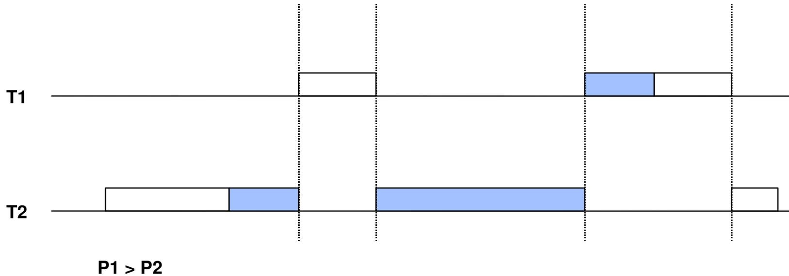
**Einfache Form des Problems: T1 wird von T2 nur so lange blockiert, wie T2 braucht, um seinen kritischen Abschnitt zu bearbeiten. Danach wird S freigegeben.**
