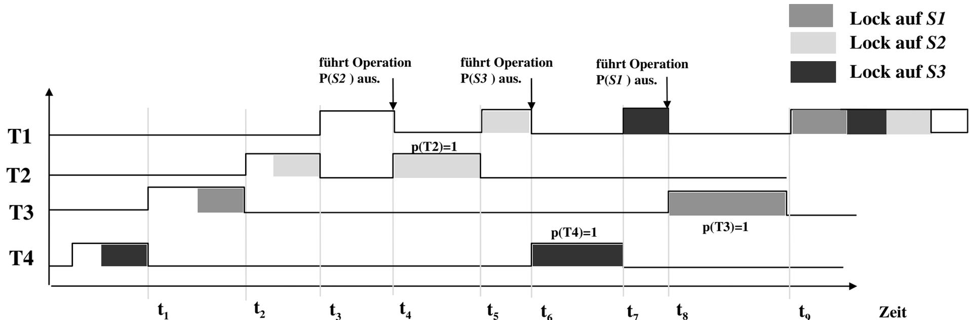
Die Task T1 wird nacheinander durch die Tasks T4, T3 und T2 blockiert. Man spricht von einer Blockierungskette (Chain of Blocking). Die Vorhersagbarkeit der Blockierungsdauer ist nicht gewährleistet.
