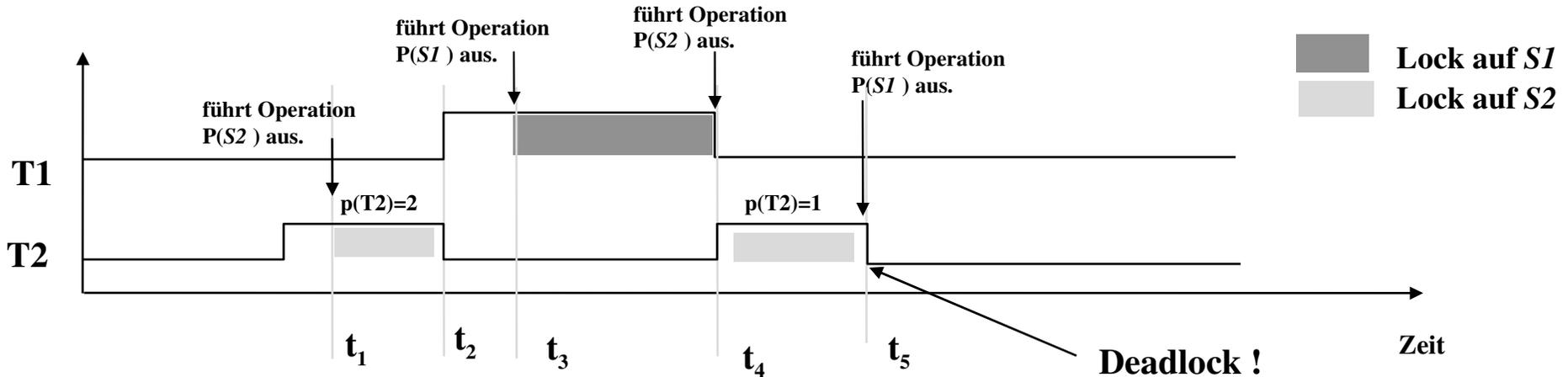
$t_1$  : T2 führt die Operation  $P(S2)$  aus, erhält den Lock und tritt in den kritischen Abschnitt ein.
