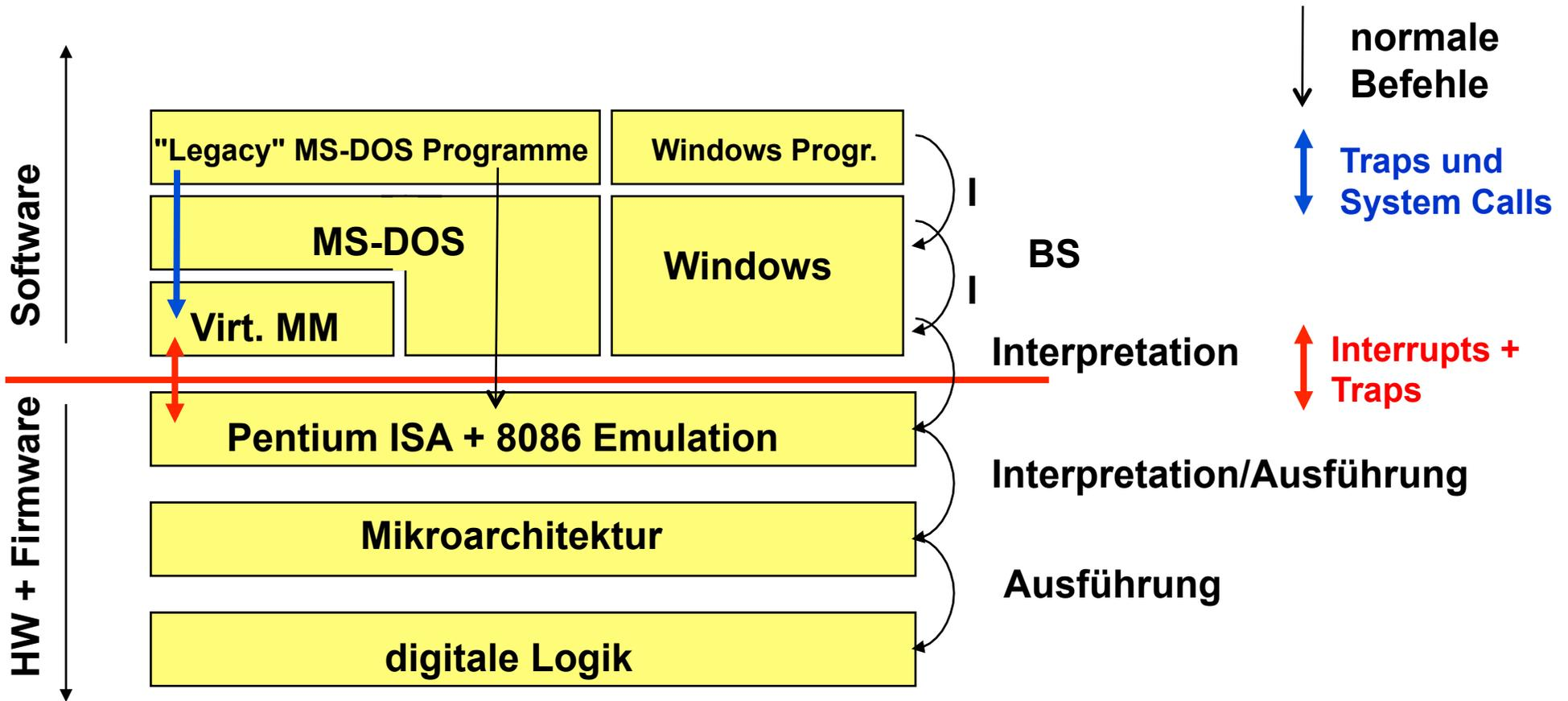
Virt. MM: Virtual Machine Monitor, emuliert 8086 Trap+Interruptverhalten
