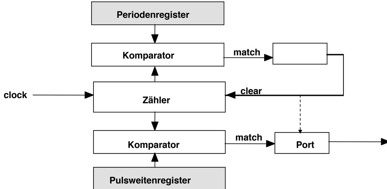
Funktion: Erzeugen von Impulsfolgen mit einer programmierbaren Frequenz und einem programmierbaren Tastverhältnis.
